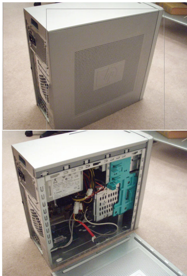
Slika 4. Skidanje desnog bočnog panela
