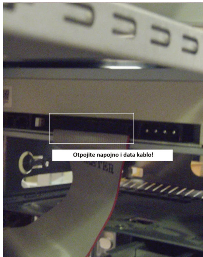
Slika 11. Mjesto spajanja podatkovnog(data) kabla CD/DVD-A
